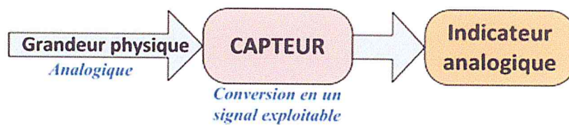
Figure 01 : Schéma bloc d'un capteur analogique. [1]
