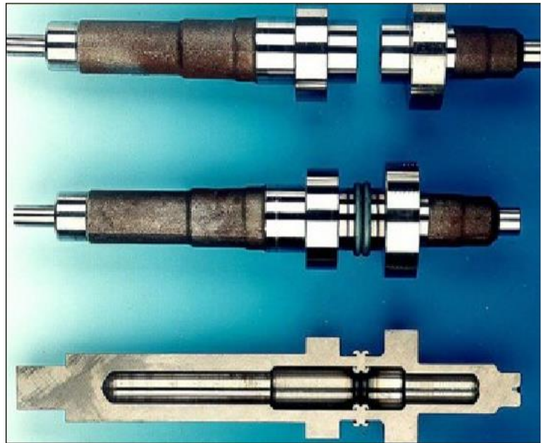
Figure II.11 — Soudage de tiges de piston
