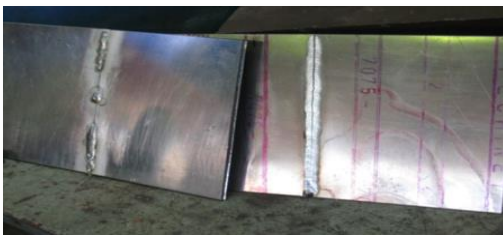
Figure I.7 — Apparition de fissures (visuel / Microscope)
