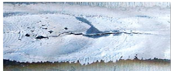
Figure I.7 — Apparition de fissures (visuel / Microscope)
