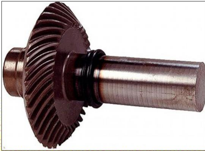
Figure II.9 — Arbres de transmission soudés par friction
