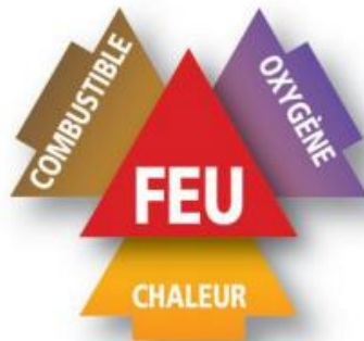
Figure 1-1: Le triangle du feu montrant l'association des trois éléments indispensables pour une combustion chimique. [5]
