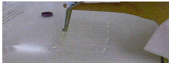
Figure8: Introduction de 10\mu\text{l} de la dernière dilution dans le puit (Originale).
