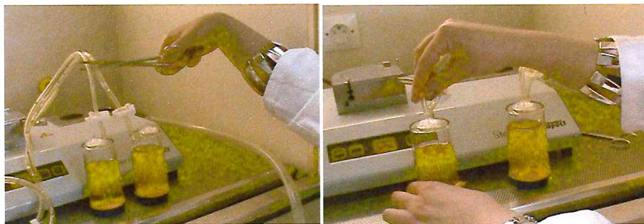
Figure 14: La coupe des tubules et leur fixation sur les canistères (Originale).
