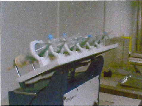
Figure : Ampoules à décantation au moment de l'agitation
