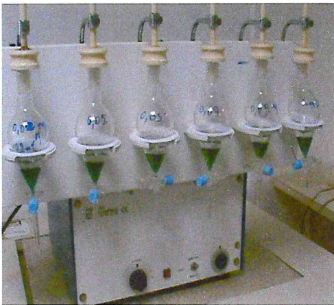
Figure : Gamme d'étalonnage après extraction
