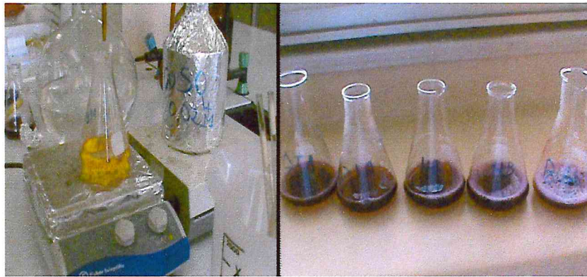
Figure 4: Après titrage et l'ajout de Pyridyl Azo naphthol (Originale).
