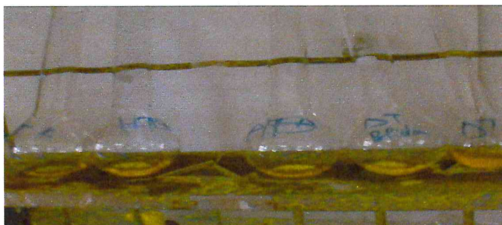
Figure 3: Neutralisation d' Al^{+3} par NaOH D'où la coloration rose jaune (Originale).
