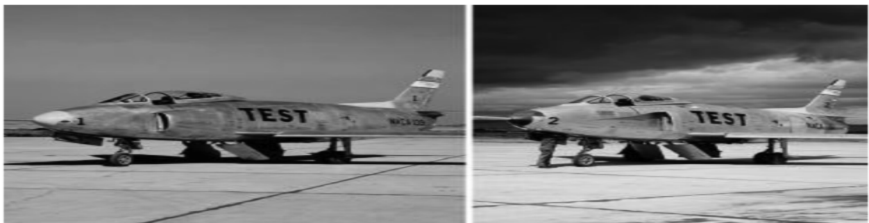
Figure I.3 L'avion de recherche North American YF-93A de la NACA, avec des prises d'air à écopes (à gauche) et des prises d'air submergées (à droite) (photos NACA, 1951).
