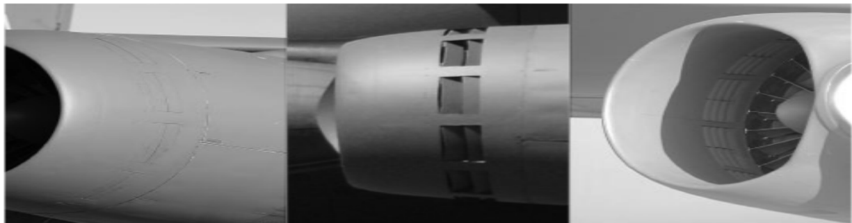
Figure I.8 Portes soufflantes sur le B-52H : fermées (à gauche), ouvertes (au centre) et vue de l'intérieur de la nacelle (à droite).
