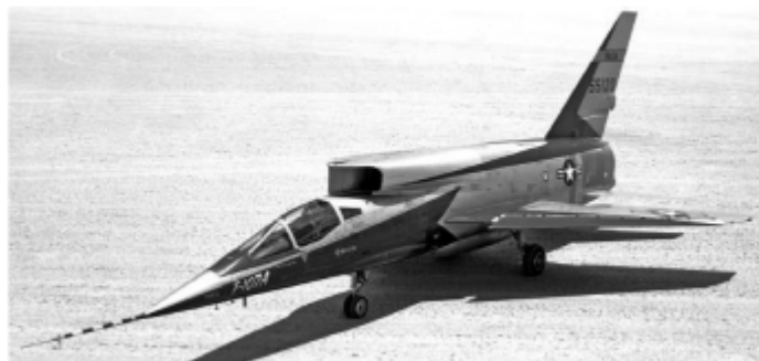
Figure I.12 F-107A nord-américain avec prise dorsale (image NASA).
