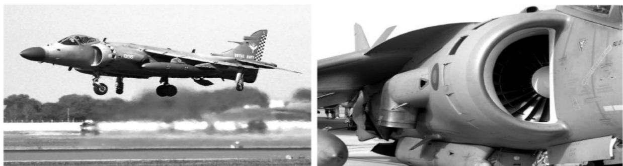
Figure I.9 Portes soufflantes sur le Harrier : complètement ouvertes en vol stationnaire (Sea Harrier FA2, à gauche) et partiellement fermées (Harrier GR.9, à droite).
