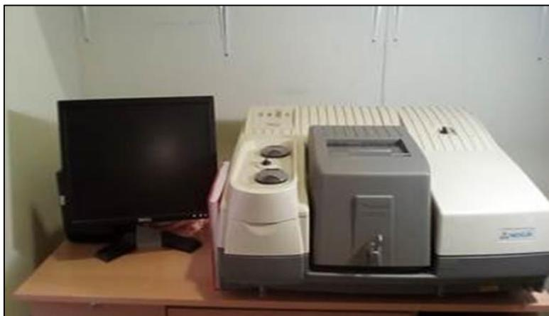
Figure III-3 : Spectroscopie infrarouge à transformée de Fourier FTIR/ATR FTIR Thermo Nicolet NEXUS 670 (CRTSE)
