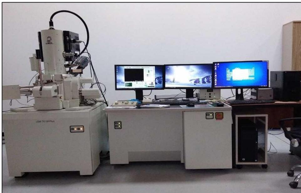
Figure III-1 : Microscopie Electronique à Balayage de haute résolution JSM-7610FPlus (CRTSE)
