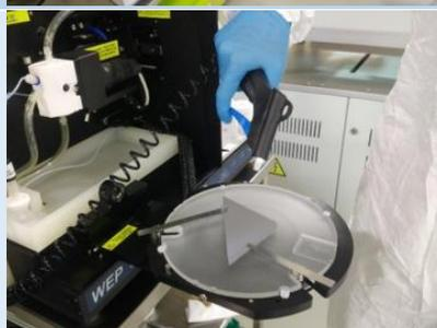
Rincez la bague d'étanchéité avec de l'eau DI et la sécher à l'aide d'un pistolet à azote. Le couvercle de l'anneau frontal a des dimensions dans l'ordre du micron et est très sensible et important pour les mesures avec contrôle précis de la zone. **NE LE TOUCHEZ JAMAIS !**
