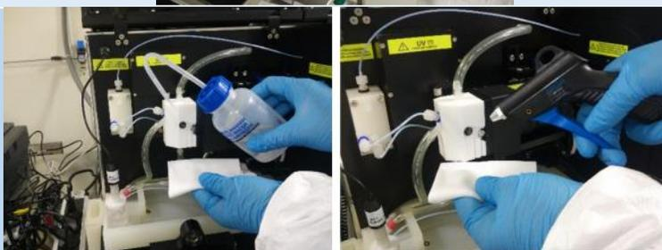
Insérer l'électrode de référence (SCE) dans la cellule.
