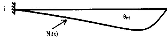
Figure III-7 : La courbe de la fonction d'interpolation N_4(x) [13].
