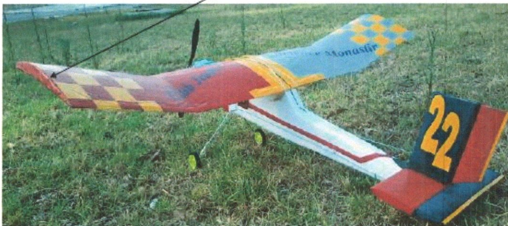
Figure I-8 : Exemple d'un profil biconvexe dissymétrique.
