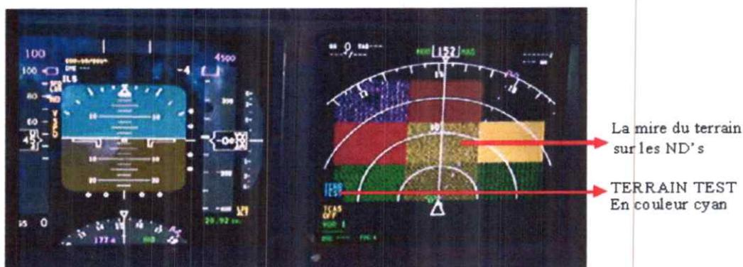
Figure 4.9: L'affichage du message « TERR TEST » en couleur cyan sur les ND's
