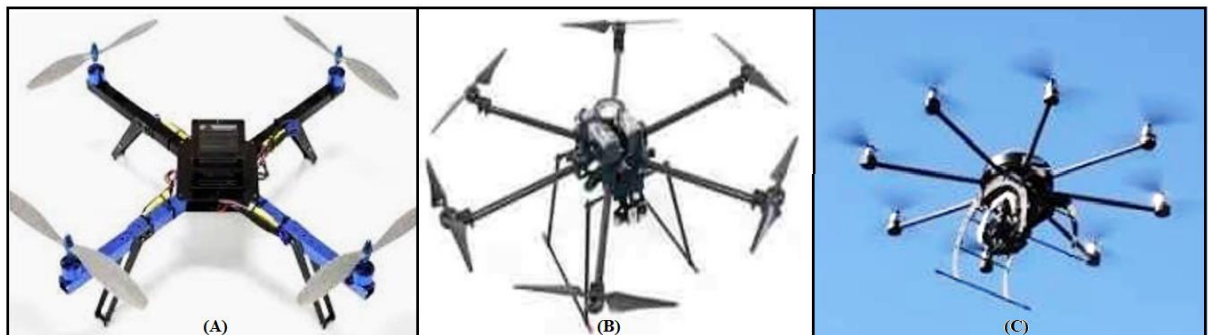
Figure 1.8 : Vues d'un quadrirotors (A), d'un hexarotors (B) et d'un octorotors (C)
