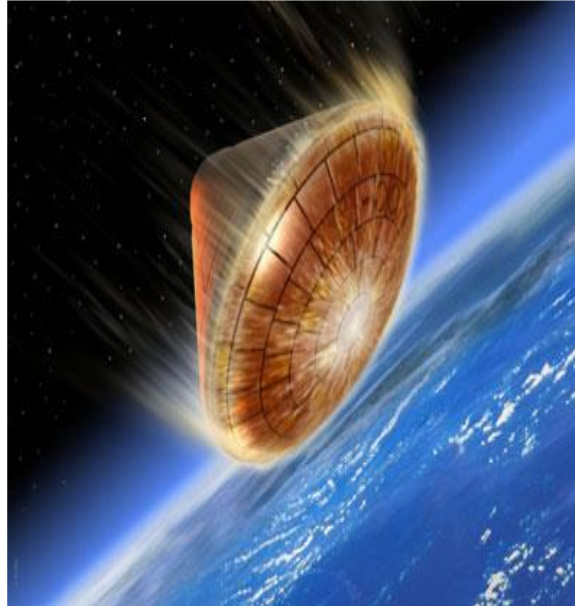
Figure 1-1 Démonstrateur de rentrée atmosphérique (ARD) libéré à 830 km d'altitude par Ariane 5[103].
