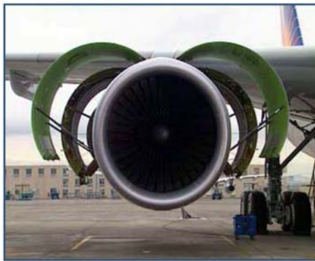
Fig. (III.1.2.a) : les capots du moteur. Fig. (III.1.2.b) : l'ouverture manuelle des capots.
