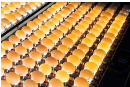
Figure 2: Procédé du mirage des œufs à couver. (FPOQ, 2021)
