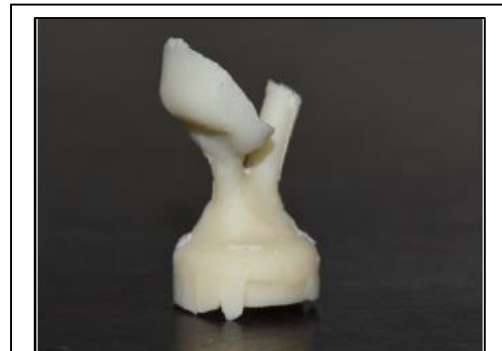
Figure III.17 : Sortie du four après retrait du revêtement. (3)
