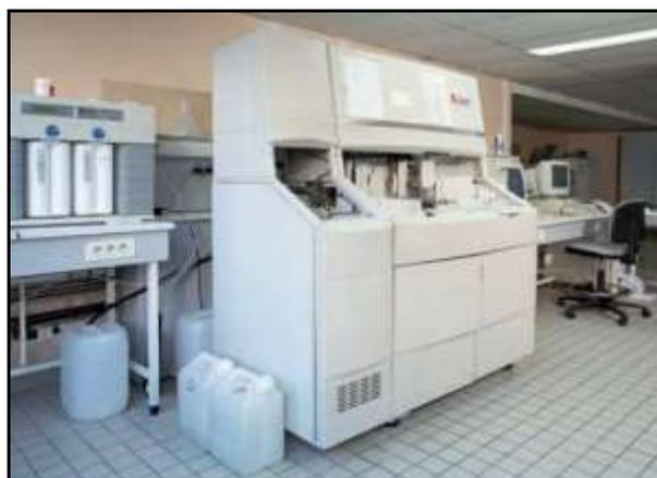
**Figure 6** : Exemple d'automate pouvant être utilisé en biochimie (Clermont *et al.*, 2018)
