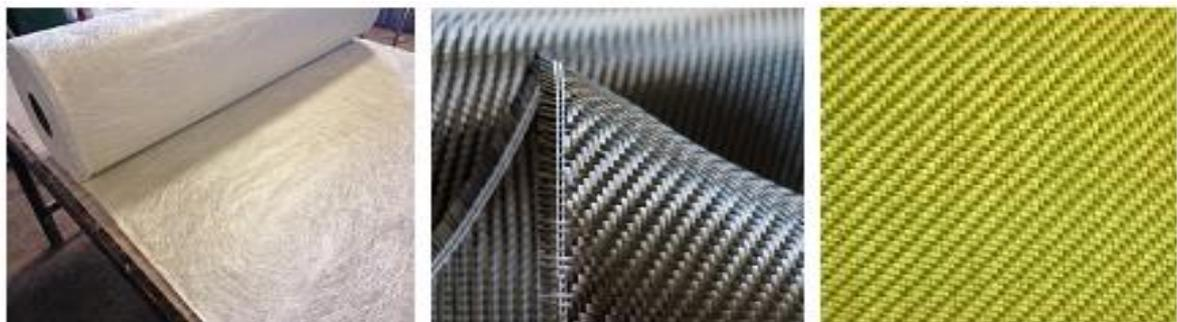
**Figure I.3 :** Exemples de tissus de renforts utilisés pour les CMO haute performance : (a) verre, (b) carbone, (c) aramide (Kevlar).
