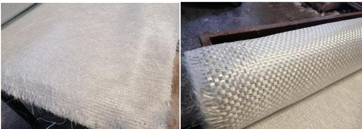
**Figure I.4 :** Fibre de verres [9].
