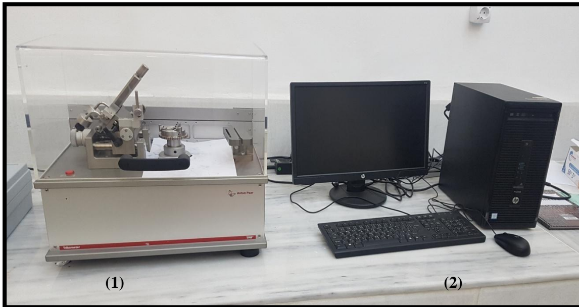
Figure 4. 7 : Le tribomètre TRB3 utilisé. (1) Tribomètre, (2) Unité de contrôle.
