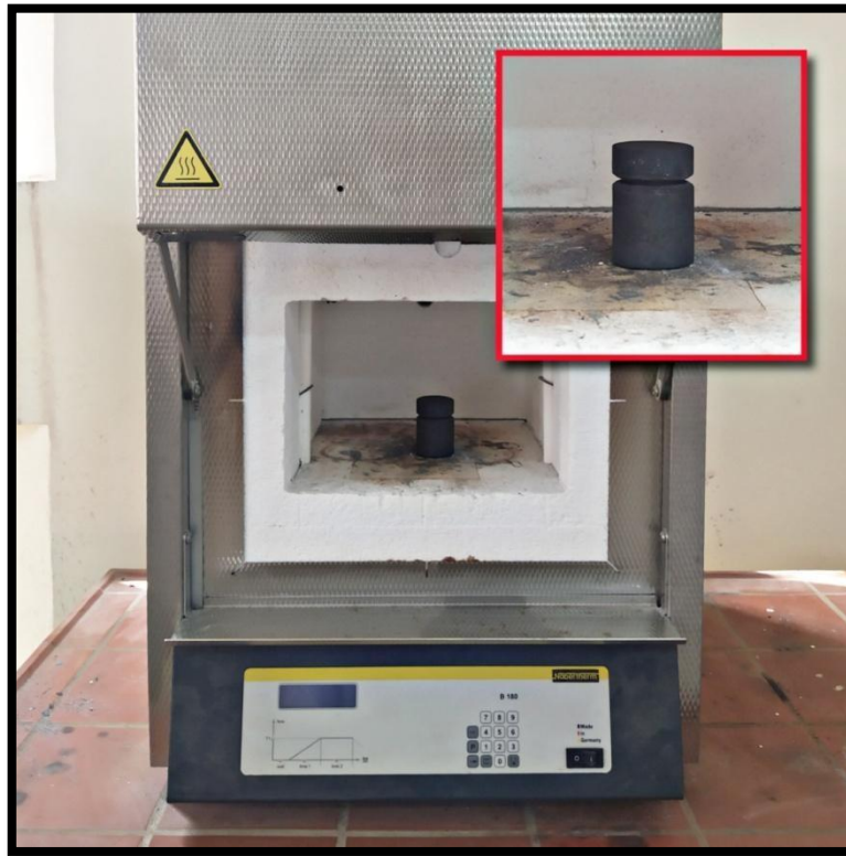
Figure 4. 6 : Le four à moufle utilisé pour le traitement thermochimique, four de type Nabertherm, notre creuset est encadré en rouge.
