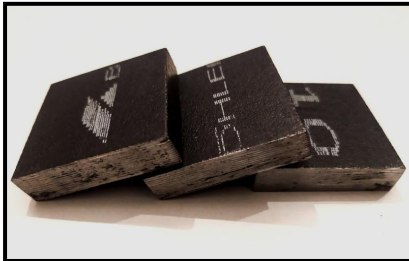
Figure 4. 1: Matériau étudié (Acier BÖHLER-K110) à outil pour le travail à froid, de forme (40x10).
