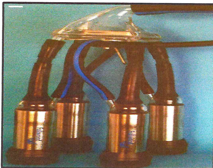
Figure n°8 : les différents composants de faisceau trayeur
