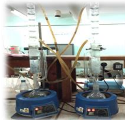
Figure II.19 : lavage de charbon par Soxhlet
