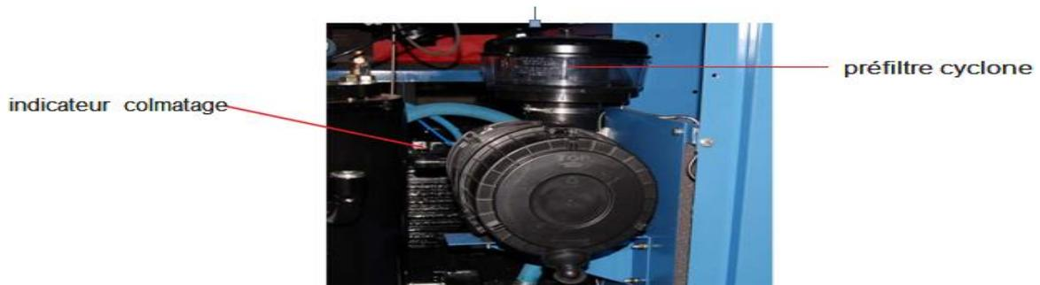
Figure II.9 : filtre à air
