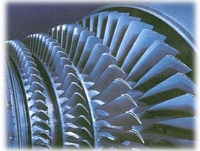
Figure I.11: les quatre étages de la turbine
