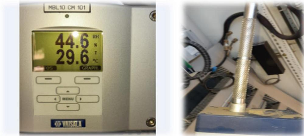
Figure II.27 : Transmetteur d'humidité et température
