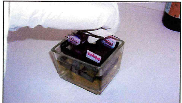
Photo 10 : Différencier avec l'acide sulfurique pendant 60 secondes
