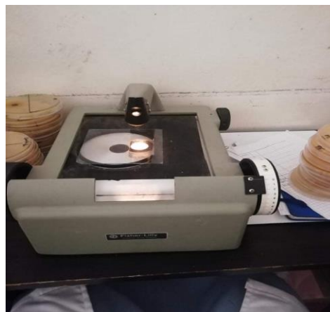
Figure 17 : Instrument optique de lecture d'un antibiogramme
