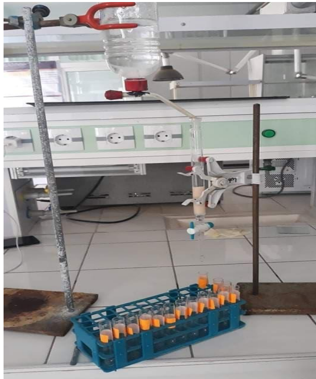
Figure 8 : Montage expérimental de l’adsorption dynamique du l’oxytétracycline sur un lit d’adsorption fixe à base de résine XAD 1180
