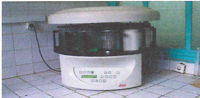
Figure 19: appareil à circulation automatique (Leica).
