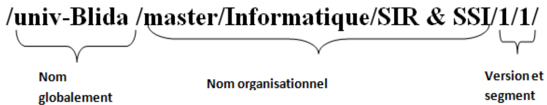
Figure I.9– Structure d'un nom de contenu dans NDN.
