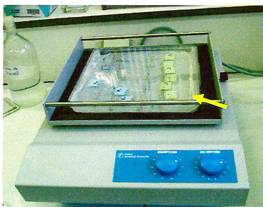
Figure 43 : Chambre humide sur un agitateur va et vient (Photo personnelle)
