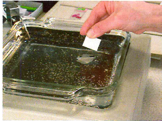
Figure 35 : Récupération de la coupe à l'aide d'une lame (Photo personnelle)
