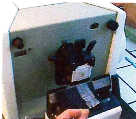
Figure 32 : Coupe au microtome type Leica (Photo personnelle)
