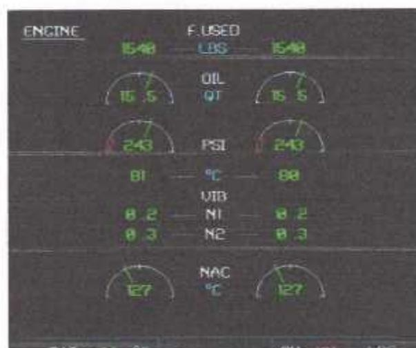
**(Figure II-17) : la page de moteur sur le SD**
