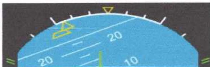
***(Figure I-6) : indicateur d'angle de virage***
