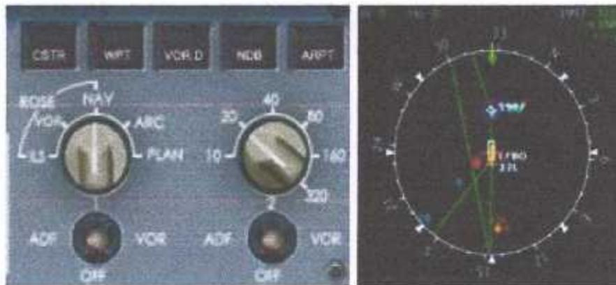
*(Figure I-21) : le mode NAV sélectionné sur le ND*
