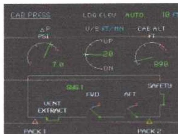
**(Figure II-22): la page de pressurisation sur le SD**
