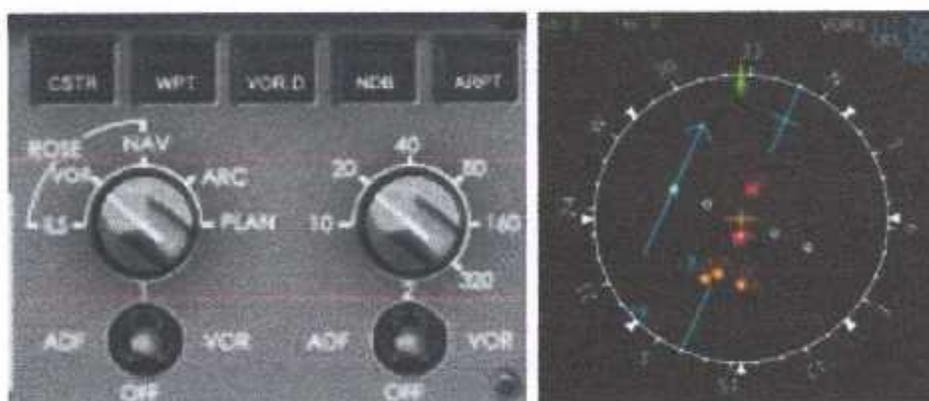
*(Figure I-20) : le mode VOR sélectionné sur le ND*
