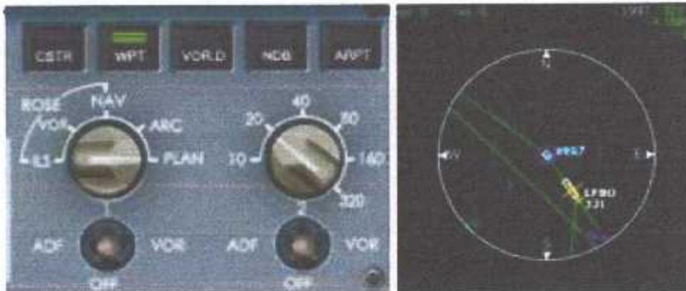
**(Figure I-23) :** le mode PLAN sélectionné sur le ND
