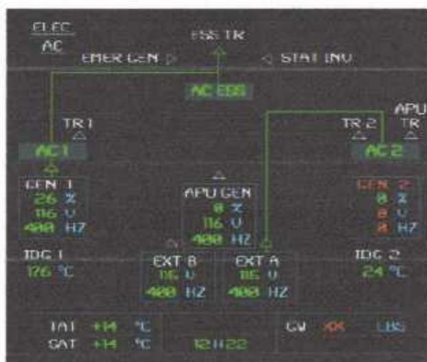
**(FIGURE II-14) :** la page d'électricité C.A sur le SD
