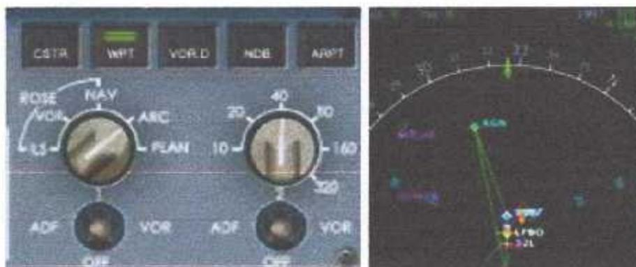
*(Figure I-22) : le mode ARC sélectionné sur le ND*
