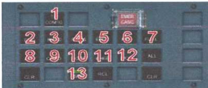
1. **TO CONFIG**: Ce bouton est utilisé pour vérifier la configuration avant le décollage.
