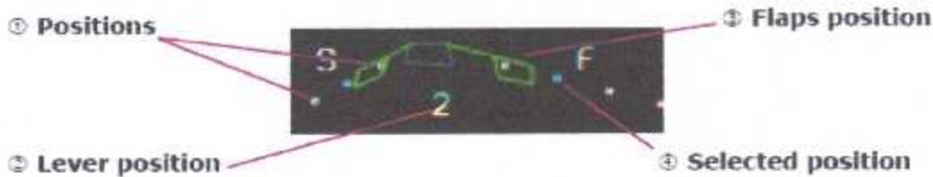
***(Figure II-08) : indicateur d'ailerons/lamelles***
