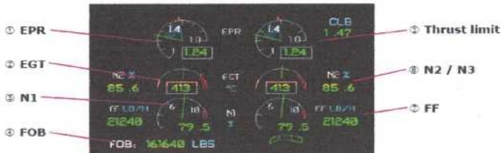
*(Figure II-06) : les paramètres de moteur*
