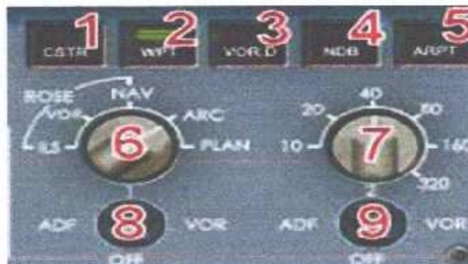
**(Figure I-18) : commande ND sur le panneau de commande d'EFIS**
