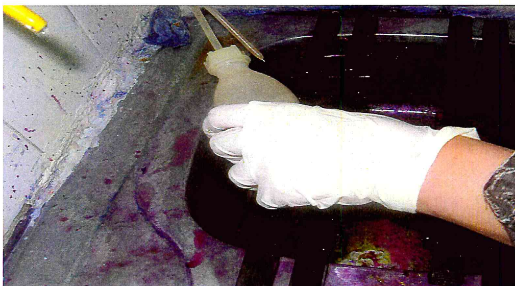
Figure n°10 : lames recouvertes d'acide sulfurique.
