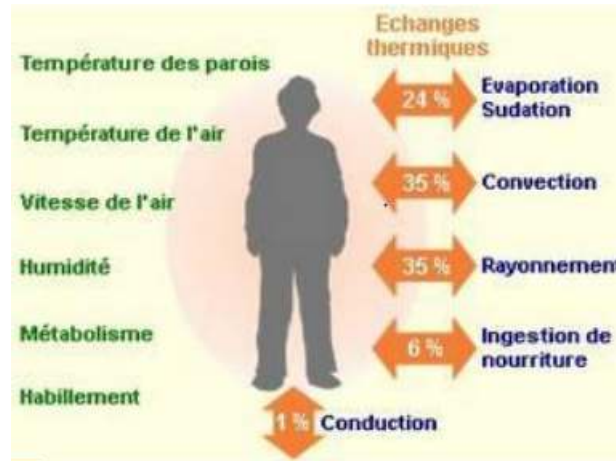
Figure I - 12 : les paramètres du confort thermique
