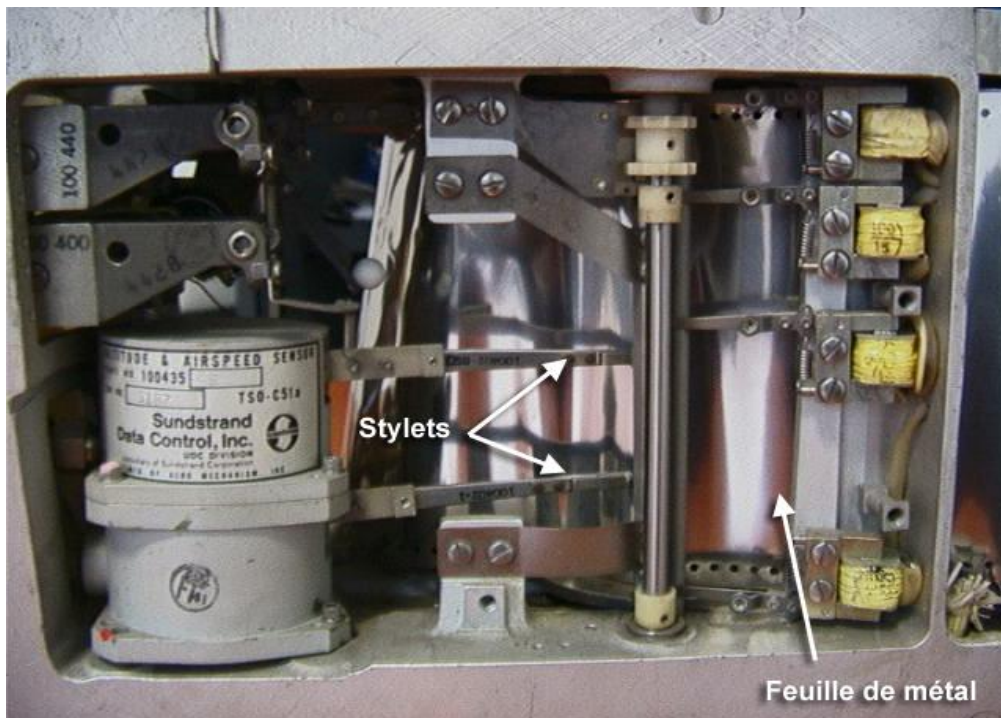
FigureII.6 : Intérieur d'un enregistreur métallique
