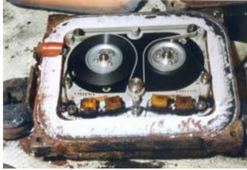
FigureII.7 : Intérieur d'un enregistreur magnétique
