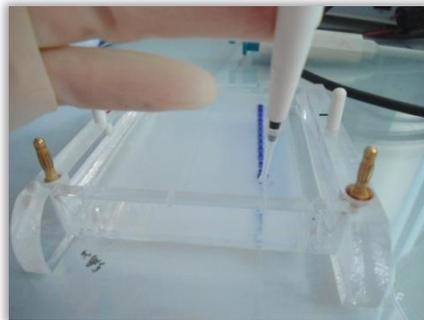
**Figure 17: Photo du dépôt d'échantillons dans une plaque de gel d'agarose (électrophorèse).**
