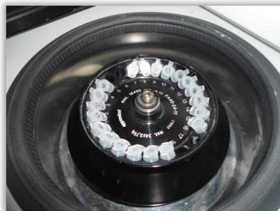
*Figure 16: Photo de la centrifugation lors de l'étape de purification.*
