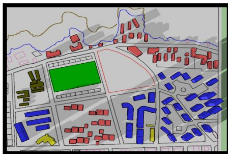
Figure 82 : l'ambrage de février 17:00h
