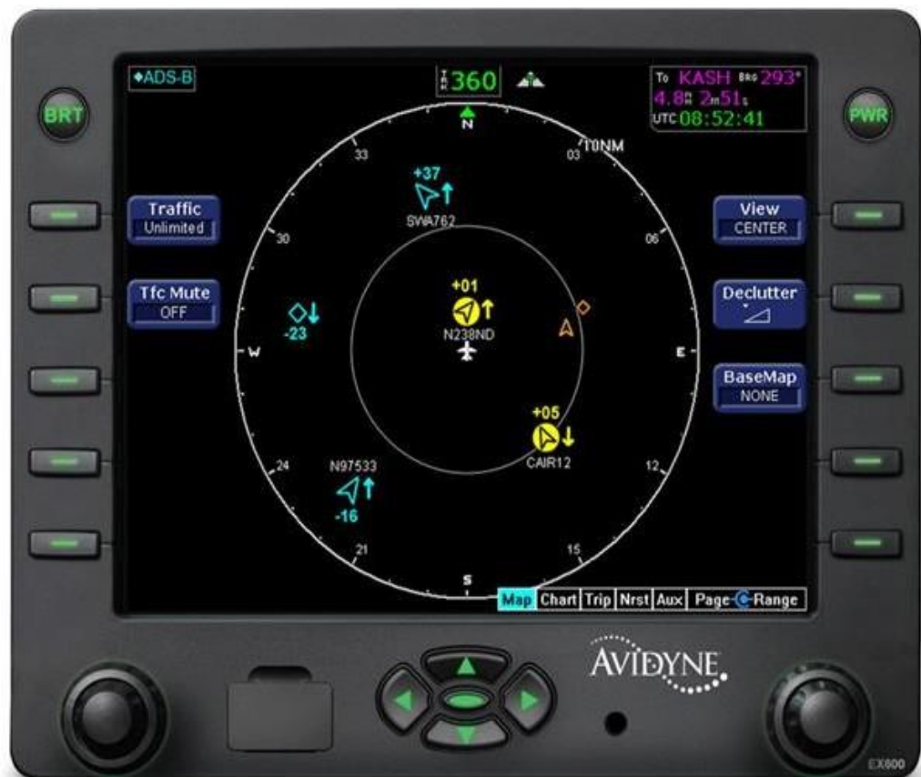
Figure 2. 12 : L'écran TAS-A d'Avidyne combine les systèmes ADS-B et de surveillance active dans une seule unité.
