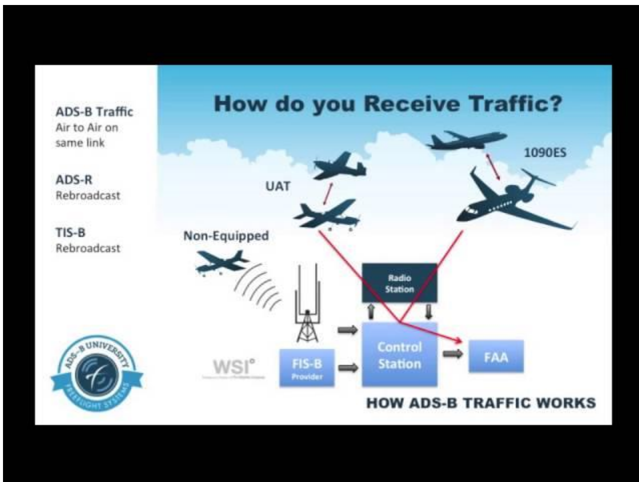
Figure 2.8 : Données de liaison montante d'aéronefs non équipés ADS-B pour la connaissance de la situation des aéronefs.
