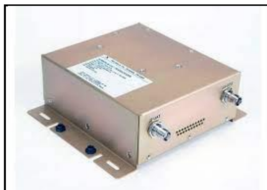
Figure 2.7 : Emetteurs - récepteurs à accès universel (UAT).
