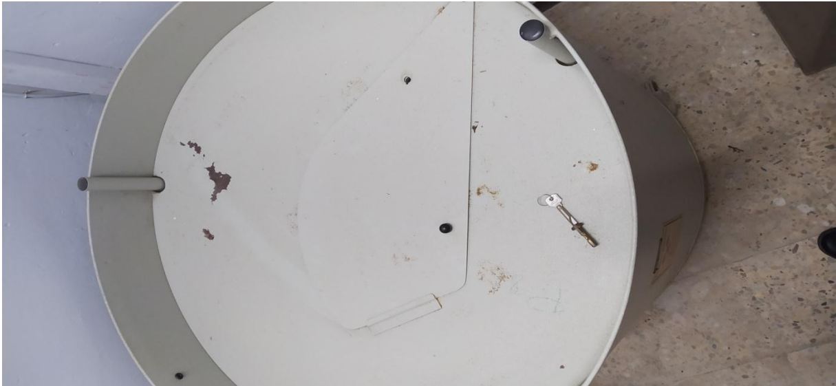
Figure 3.4 : Image de la source de neutrons( ^{226}\text{Ra\_Be} )
