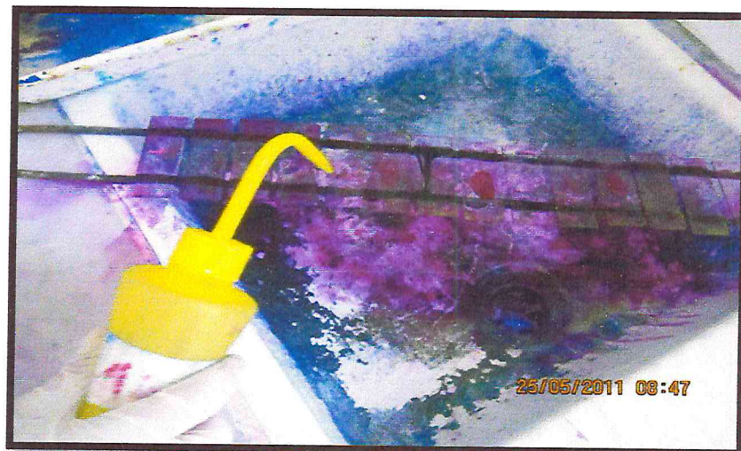
Figure 7 : Lames recouvertes d'acide sulfurique
