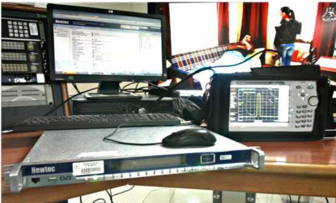
Figure 3.1. Banc d'équipement servant au test de l'occupation spectrale
