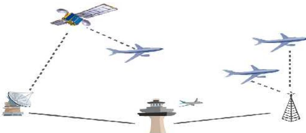
Figure 4.3. Les systèmes de communications pour le contrôle aérien
