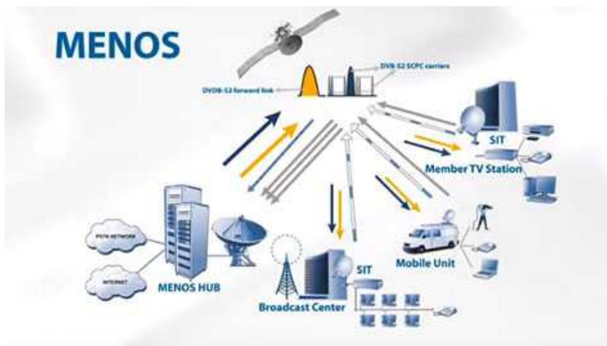
Figure 4.12. Schéma synoptique du réseau MENOS basée sur le DVB-RCS
