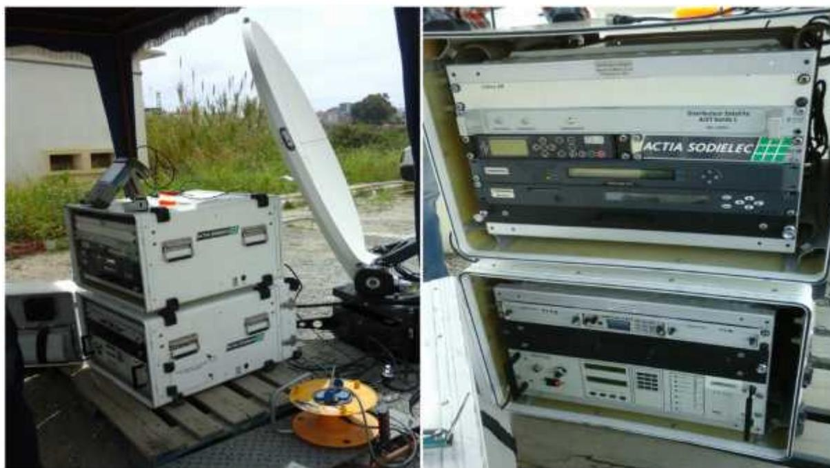
**Figure 3.12. La chaîne de transmission DVB-S/DVB-S2 sur le satellite SES4 (22°W)**
