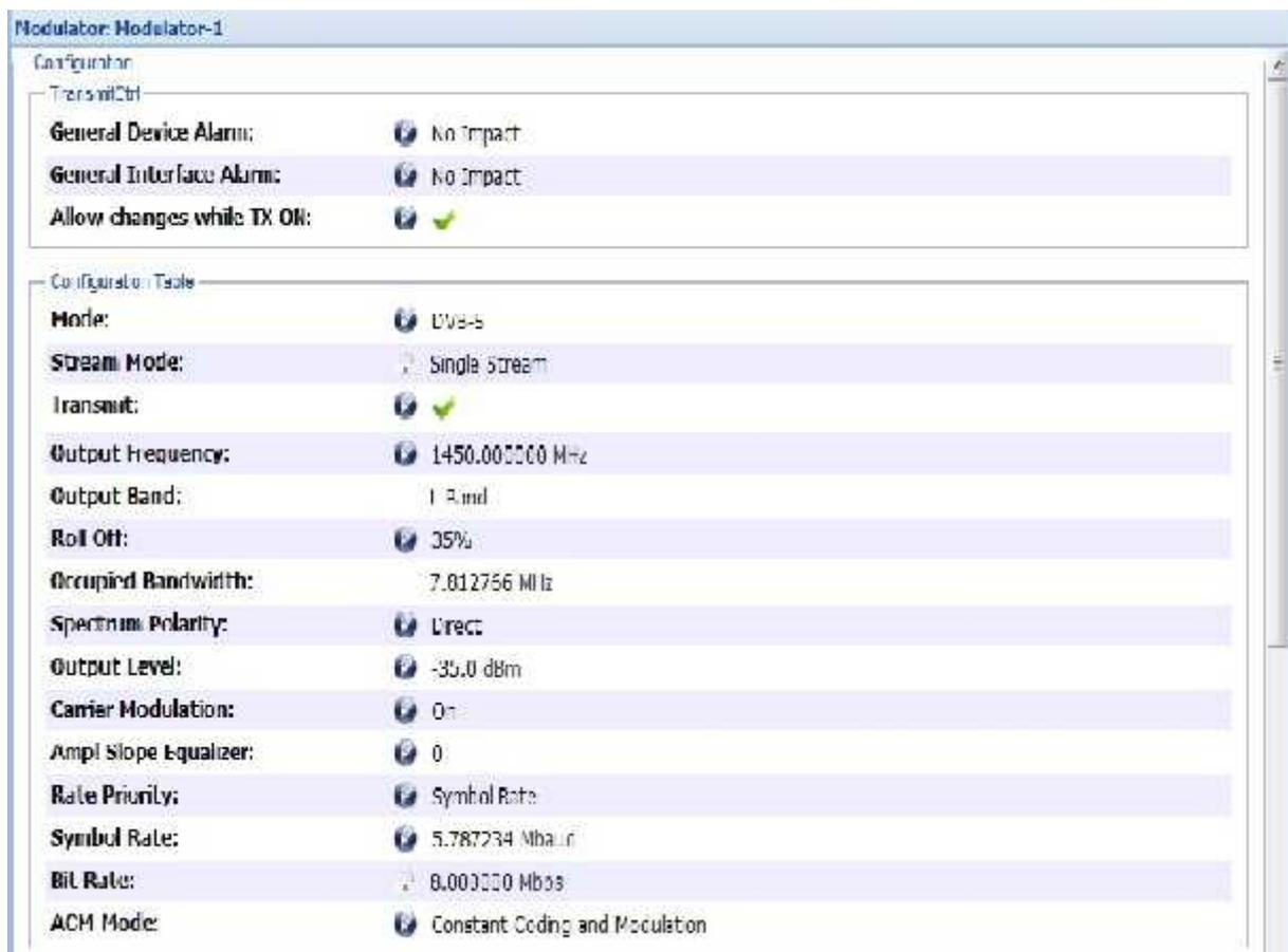
Figure 3.5. Interface du Modulateur M6100 de NEWTEC
