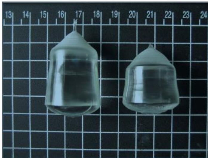
Figure 1.13 : les boules de cristal  $\text{Yb}^{3+} : \text{NaY}(\text{WO}_4)_2$  à l'état brut. [42]
