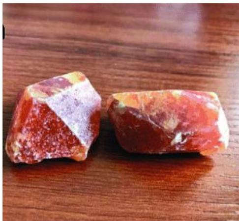
Figure 1.4 : Échantillons de cristal de scheelite pur [24]
