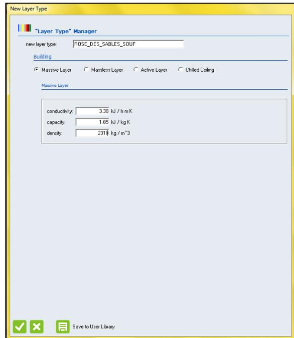
Figure 69 : Introduction des caractéristiques des matériaux. Source : auteur depuis Trnsys17.
