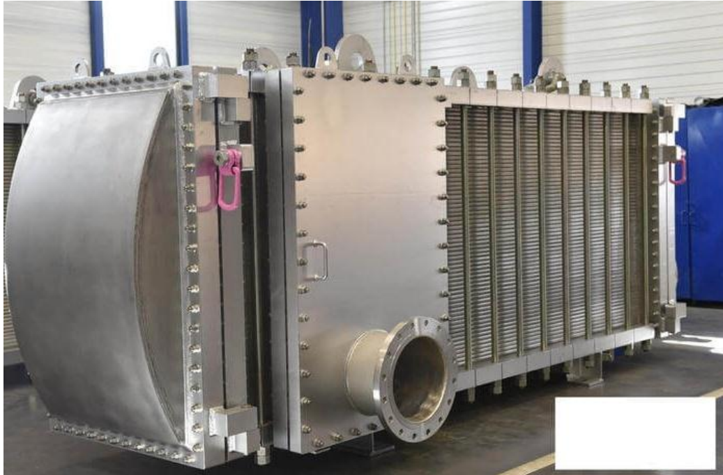
Figure 2.8 : Echangeur récupérateur ORC
