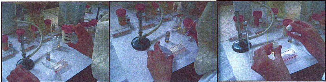
Photo 7: Homogénéisation du lait. Photo 8: Inoculation des puits. Photo 9: Ajout de l'huile de paraffine.
