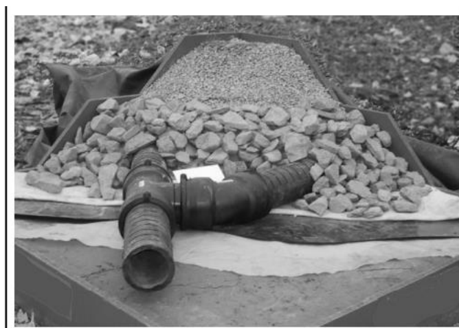
Figure 2.13 : Différents composants d'un fond de casier
