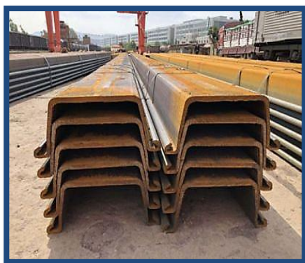
Figure I.7 Vue de rideau palplanche
