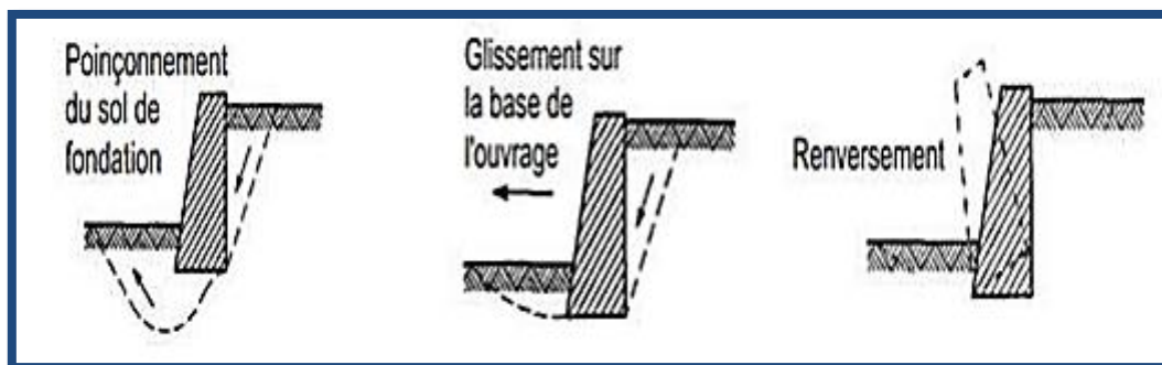
Figure I.16 Trois types de stabilité externe [18].
