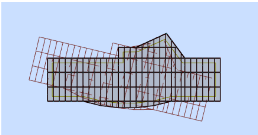
Figure 5. 10: 3ème mode de torsion autour de l'axe Z du modèle finale.
