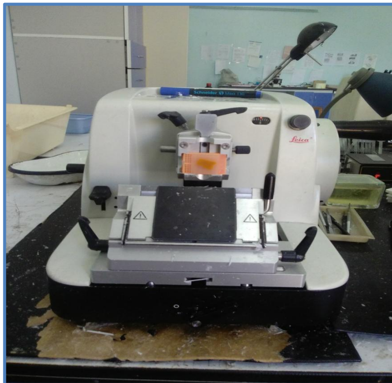
Figure 26: Microtome de type Leica au niveau de laboratoire d'anatomopathologie de l'école nationale supérieure des sciences vétérinaires d'Alger El Harrach (Photo
