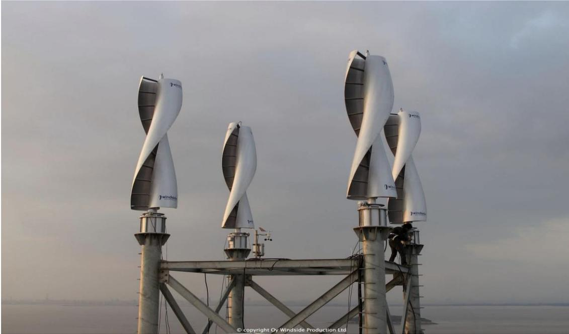
**Figure 1.5 :** Eolienne de type Savonius [15]
