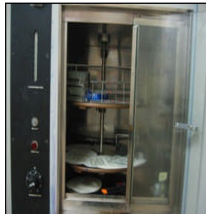
Figure 25 : séchage des coupes dans l'étuve (photo personnelle, 2018).
