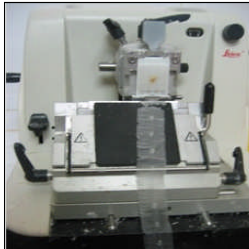
Figure 23 : confection des coupes au microtome à 5 \mu\text{m} (photo personnelle, 2018)
