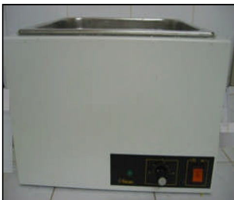
Figure 24 : ramassage des coupes à la paraffine au bain marie et étalement les sur une platine chauffante (photo personnelle, 2018).
