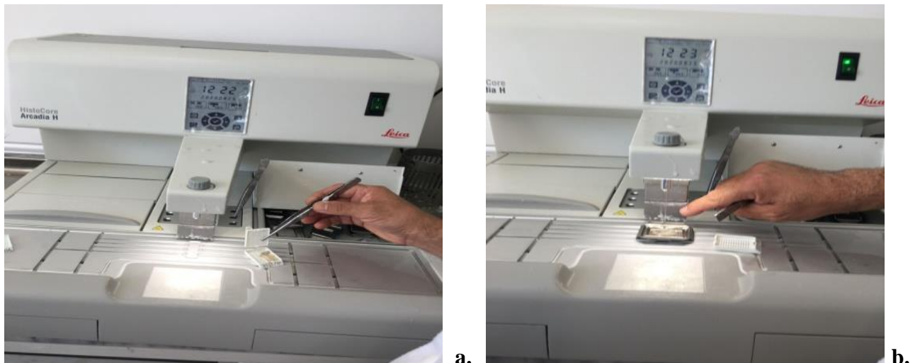
Figure 13 : L'appareil d'inclusion; a. choix de moule ; b. Versement de paraffine
