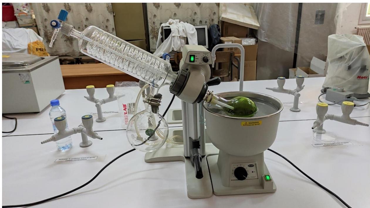
**Figure 14** concentration à l'aide d'évaporateur rotatif (Original).
