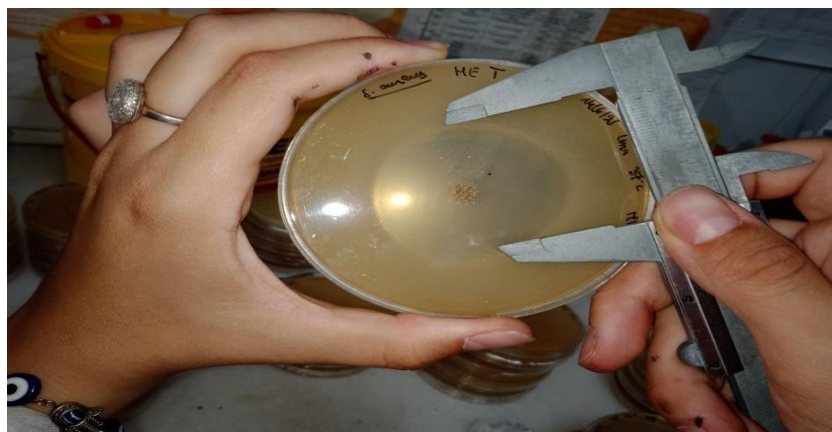
Figure 22 : Mesure du diamètre de la zone d'inhibition (DZI) par un pied de coulisse.
