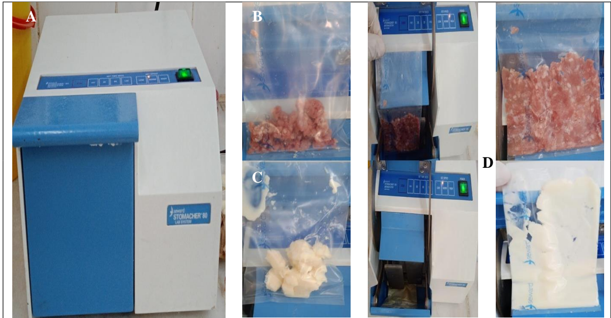
Figure 30: Etapes de la préparation des denrées alimentaires à analysées. (A) : Appareil Stomacher, (B) : Viande hachée bovine, (C) : Fromage frais, (D) : les échantillons homogénéisés.
