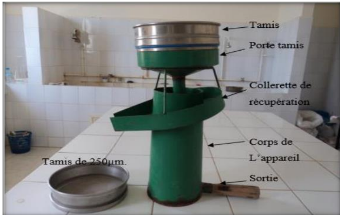
Figure 07 : Méthode d'extraction des nématodes à kyste appareil Fenwick (Fenwick, 1940).
