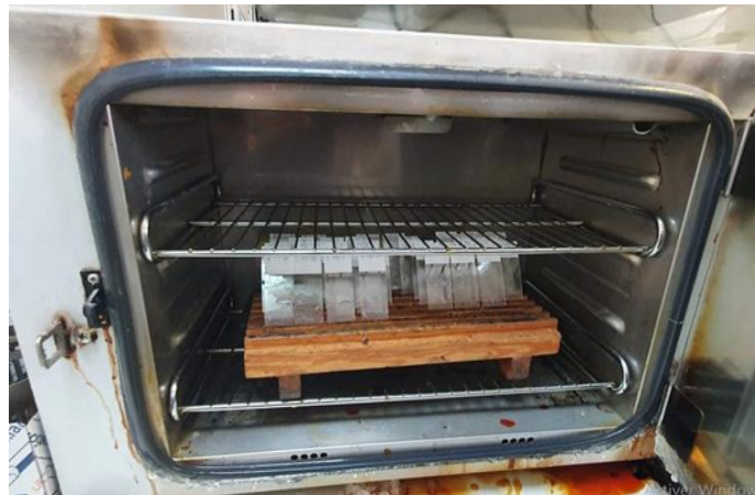
Figure 19: Séchage des lames dans l'étuve.
