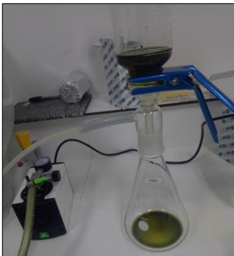
**Fig.2:** Photo réel de Dispositifs de filtration
