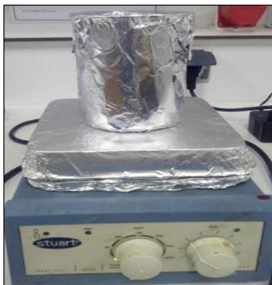
**Fig.1** : Photo réel d'un Agitateur magnétique
